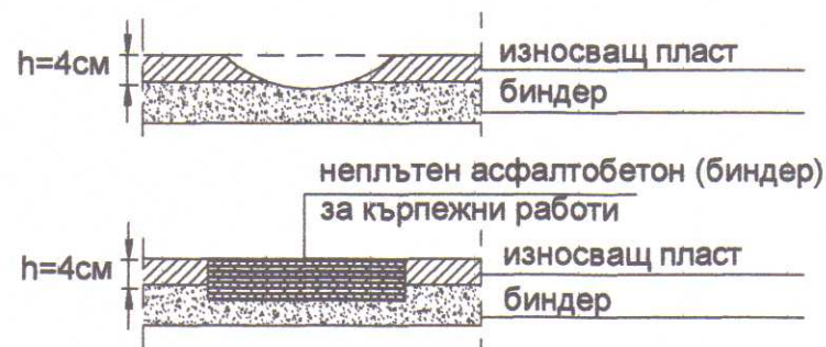
ДЕТАЙЛ No4 -Изкърпване на дупки
